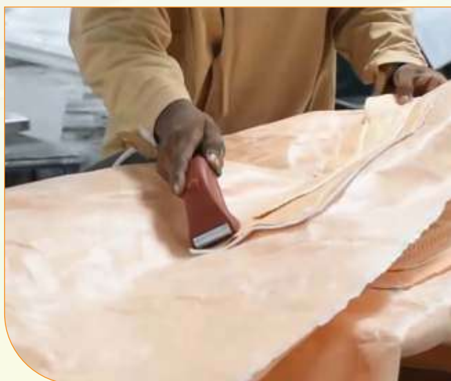
バキュームトリマーは、残っている糸のはみ出しを軽減するのに役立ちます
