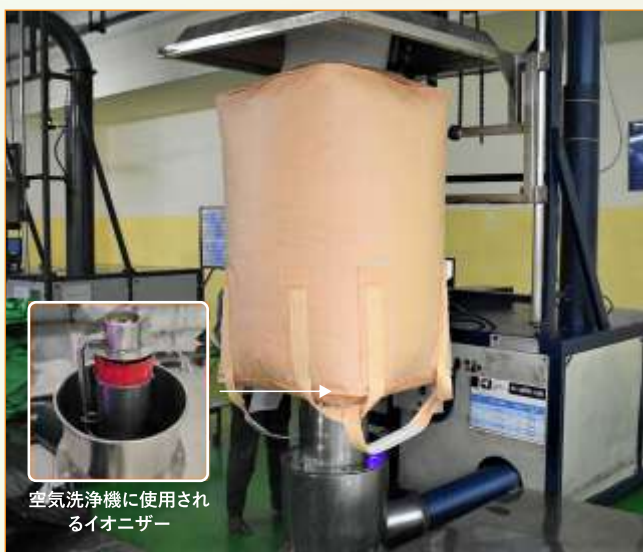
バッグのエアウォッシュでバッグの内側までしっかり洗浄
